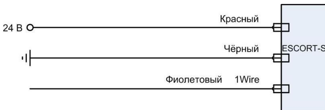
Рис.5 Подключение приёмопередатчика в режиме Считыватель
